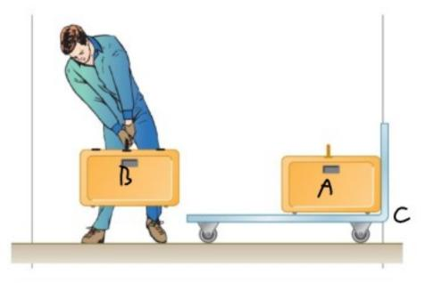
$$M_A V_A + M_B V_B + M_c N_c = M_A V_A' + M_B V_B' + M_c V_c'$$
